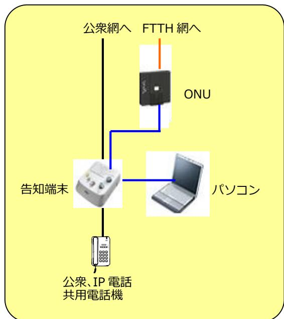
図4. ISDN を解約した場合の接続構成
